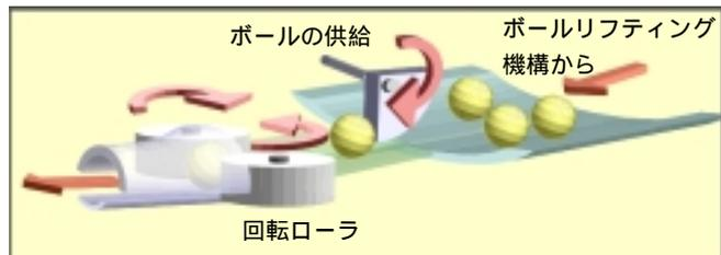
2. ベルト機構で打ち出し部に球を供給する
