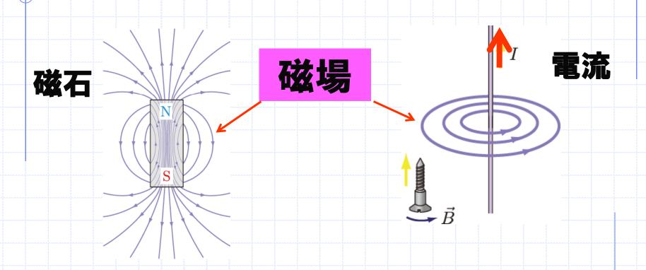
磁場は磁石だけではなく、電流によっても生じる
