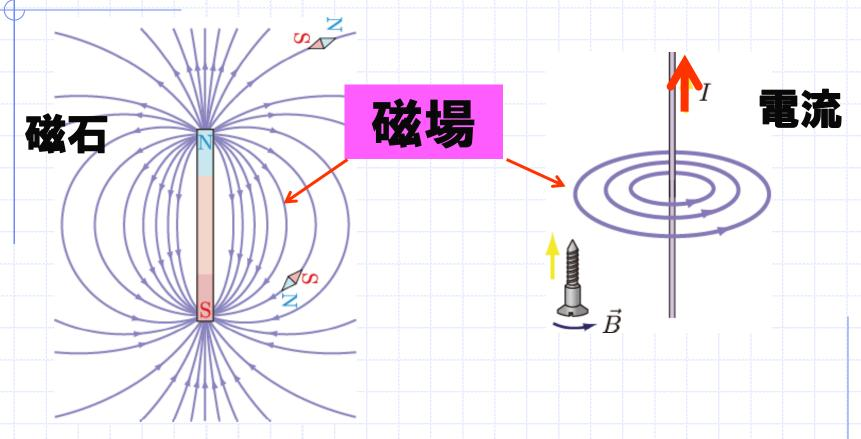
磁場は磁石だけではなく、電流によっても生じる
