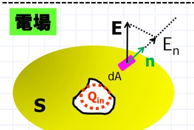
電場Eは電荷から電気力線が湧き出すため 閉曲面S内部にある電荷により面積分は
