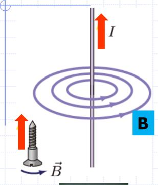
電流を流すと、電流の方向を右 ネジの進む方向として、右ネジの 回る向きに磁場が生じることを発 見した。電流とそのまわりにでき る磁場との関係をあらわす法則 を「アンペールの法則」と呼ぶ。
