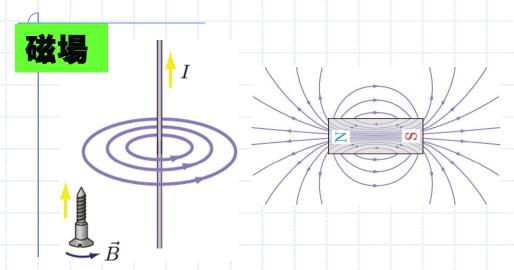
磁場Bの磁力線は始点と 終点がない閉曲線である.
